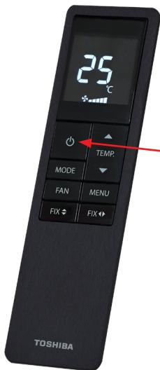
Skjermen på fjernkontrollen lyser opp når PÅ-knappen betjenes. Tall og symboler vil lyse svakt så lenge varmepumpen er på. Det vil tennes et rundt lys på innedelen ved oppstart.
